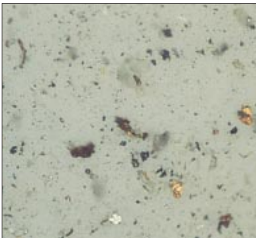
Fluido ISO 21/19/17 (ampliação 100x).
